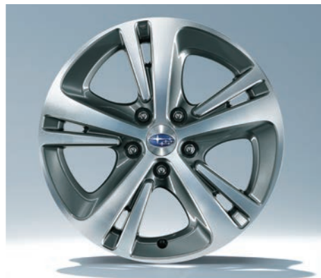
■ アルミホイール: 17インチ(ガンメタリック塗装+切削光輝)
