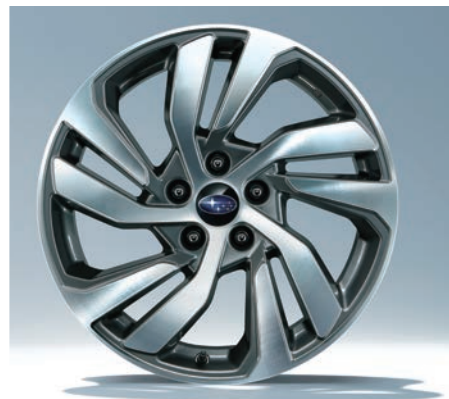
■アルミホイール:18インチ(ガンメタリック塗装+切削光輝)
